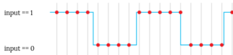
Figura 4.2.4. Muestreo de la señal de entrada.
